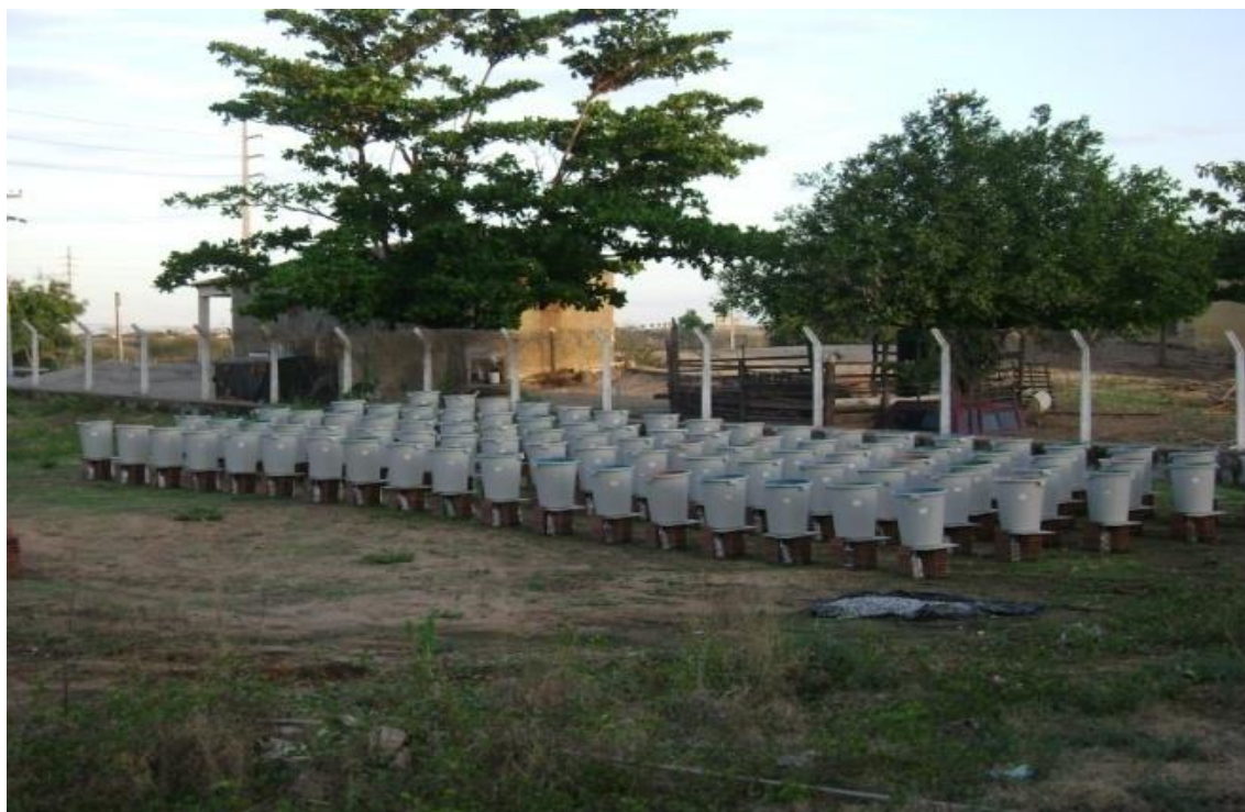
Figura 1: Disposição dos lisímetros na área experimental. Pombal, PB, 2013.
