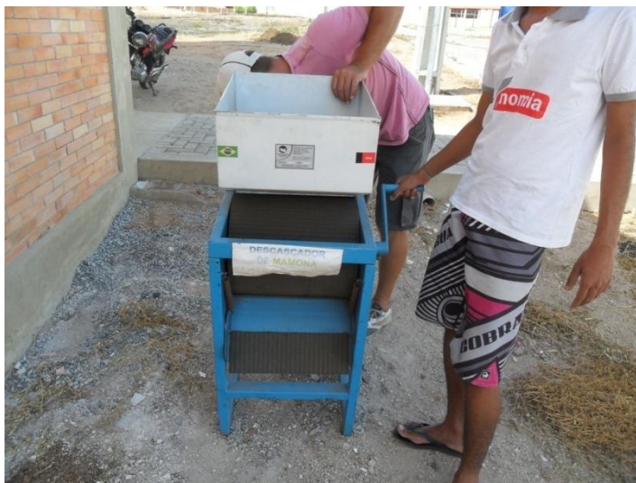
Figura 10. Protótipo fornecido pela Embrapa Algodão, para beneficiamento da mamoneira. Pombal – PB, 2011.
