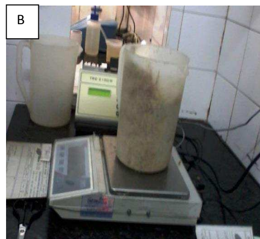
Figura 4: 'A', Amostra desintegrada e homogênea, pesando 2 kg; 'B' Amostra pesando 0,5 kg, retirada da amostra desintegrada. Santa Rita- PB, 2014.
