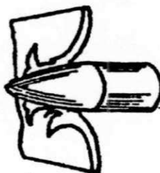
Figura 4.12 - Fratura com aparência de pétala com formato triangular e tridimensional. Fonte : Silva e Medeiros (1988).
