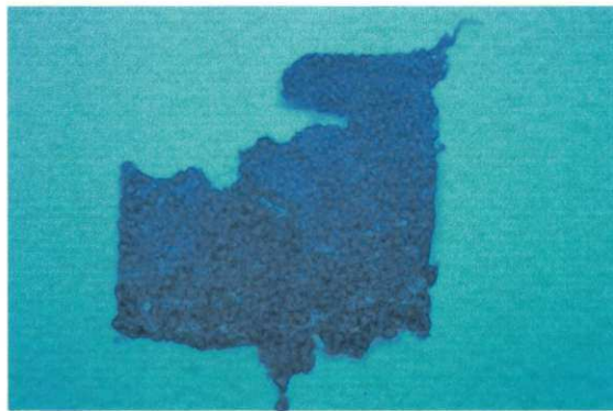
Figura 4.46 - Interface de espuma de poliuretano depois de impactada balisticamente.
