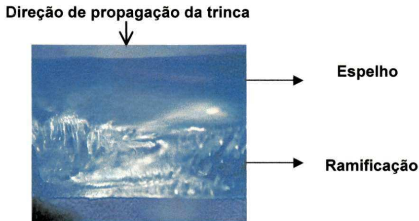
Figura 4.3 - Superfície de fratura das trincas radiais do policarbonato
