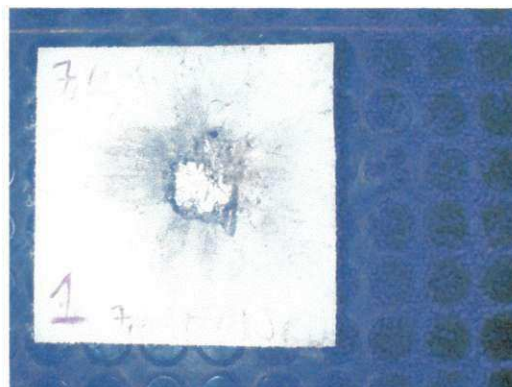
Figura 4.16- Fragmentos cerâmicos colados a placa de PEUAPM mesmo após o impacto.
