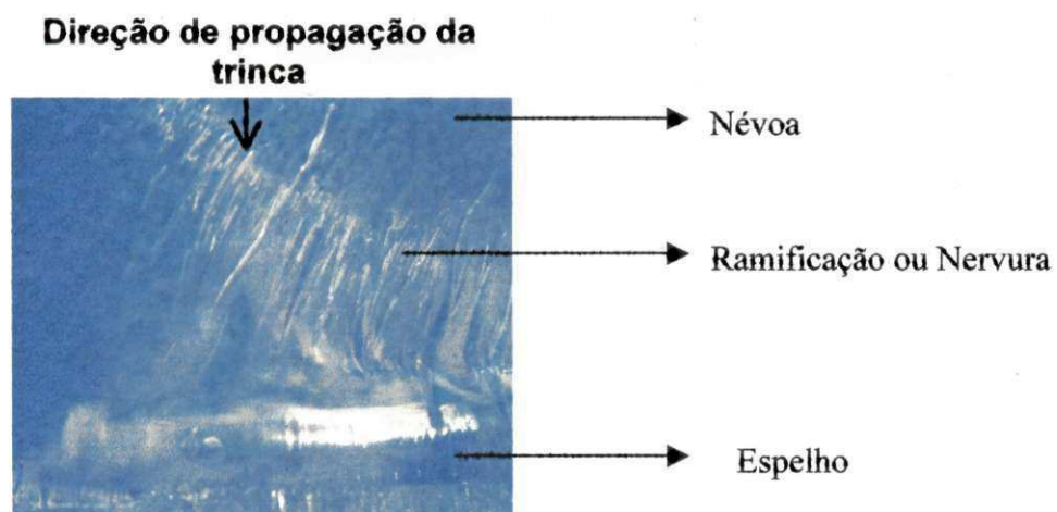
Figura 4.8 - Superfície de fratura das trincas radiais da placa de acrílico.
