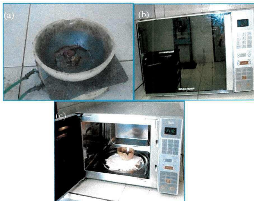
Figura 1228 - (a) Reagentes após pesagem; (b) microondas fechado com cadinho no interior e pré-programado para a reação; (c) após a reação.
