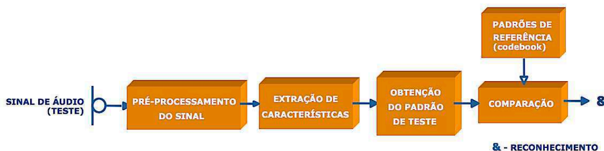
Figura 4.13 – Fase de classificação genérica (Teste) para “para detecção de Patologias”.
