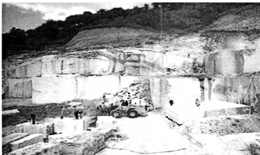
Figura 2.2 – Extração de blocos de rochas ornamentais Fonte: NEVES (2003)
