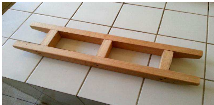
Figura 9 – Fôrma de madeira utilizada na moldagem.
