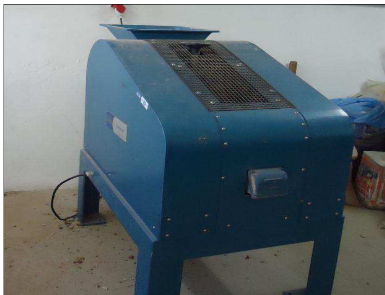
Figura 7 – Britador de mandíbulas usado para a britagem do entulho.
