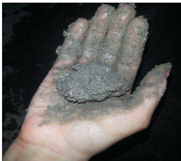
Figura 8 – Teste da mão ou método do ponto de pelota.
