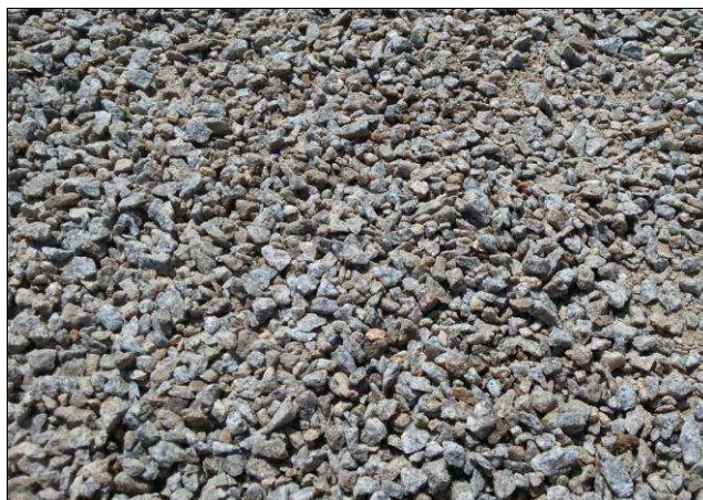
Figura 3 – Brita zero granítica utilizada na pesquisa.
