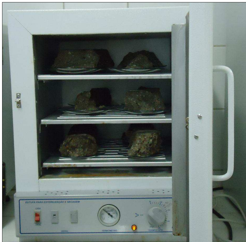
Figura 13 – Amostras em processo de secagem na estufa.
