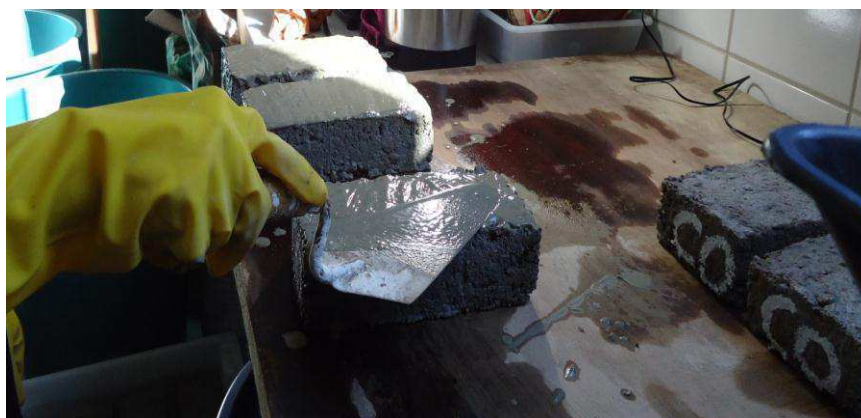
Figura 11 – Pavers sendo capeados com pasta de cimento e água.
