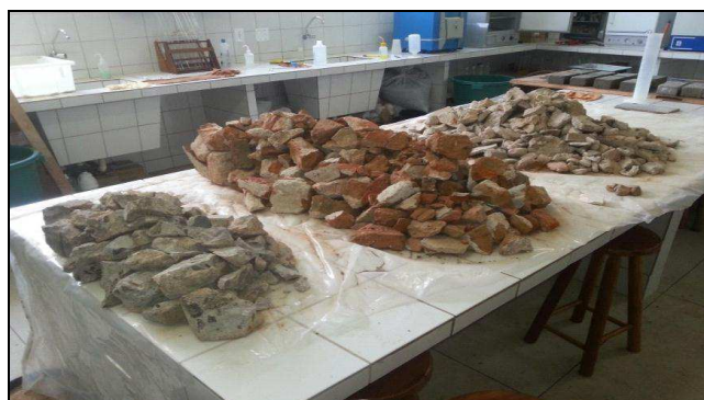
Figura 6 – Segregação dos materiais presente na amostra.
