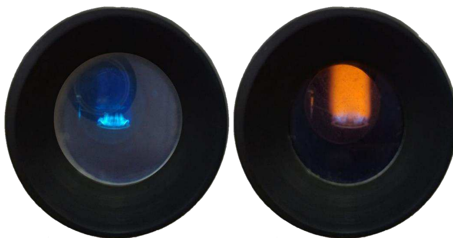
Figura 15. Chama específica do fotômetro de chamas. Azul: água destilada, laranja: Sódio.
