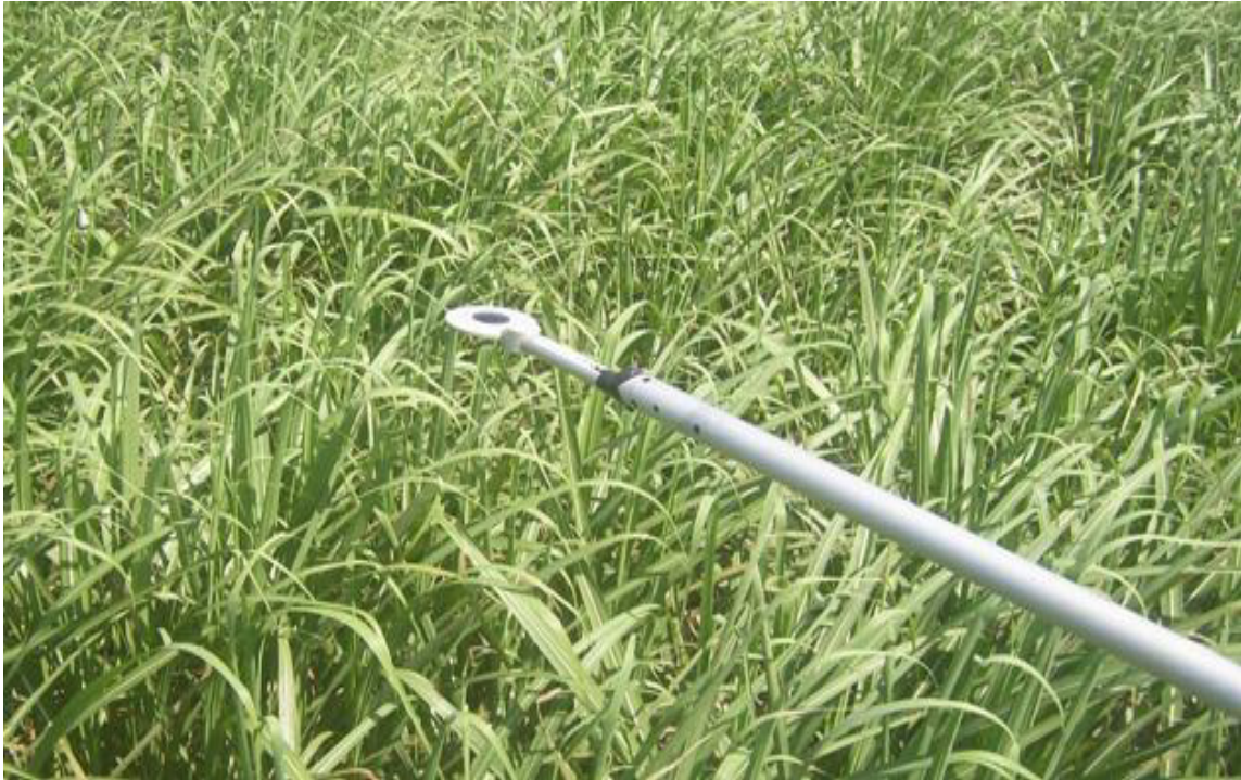
Figura 3.3 - Saldo radiômetro instalado acima da cobertura vegetal da cultura da cana-de-açúcar. 2011/2012
