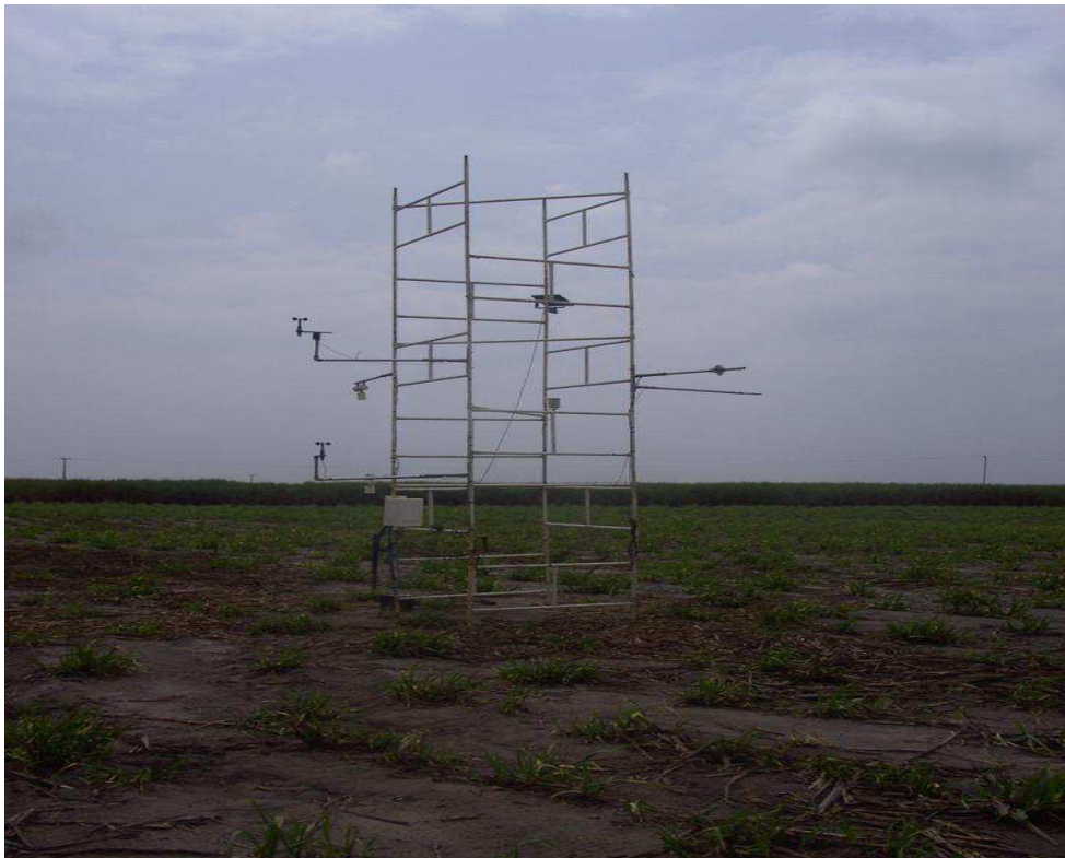
Figura 3.2 - Torre micrometeorológica com visualização dos sensores instalados, 2011/2012
