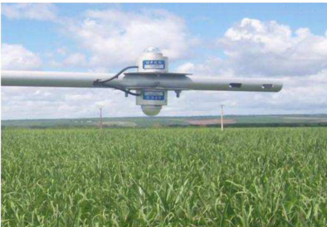
Figura 3.6 - Piranômetros instalados acima da cobertura vegetal do cultivo da cana-de-açúcar. 2011/2012
