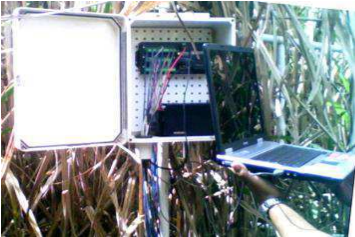
Figura 3.7 - Sistema de coleta automática dos dados micrometeorológicos (Datalogger) e coleta de dados via notebook. 2011/2012
