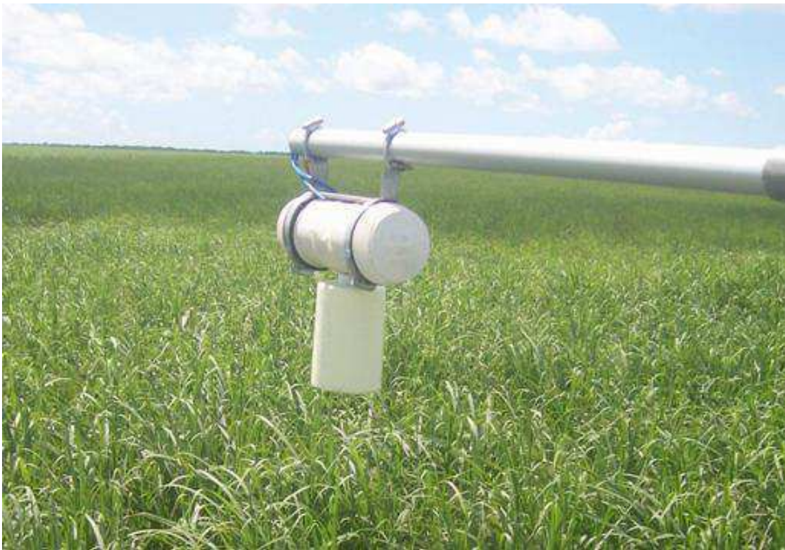
Figura 3.4 - Psicrômetro instalado acima da cobertura vegetal do cultivo da cana-de-açúcar. 2011/2012
