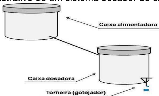
Figura 11. Esquema ilustrativo de um sistema dosador de cloro por gotejamento.
