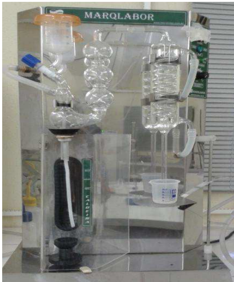
Figura 9 - Destilador de nitrogênio utilizado para destilação das amostras - Laboratório de Bioquímica e Biotecnologia de Alimentos (CES/UFCG)
