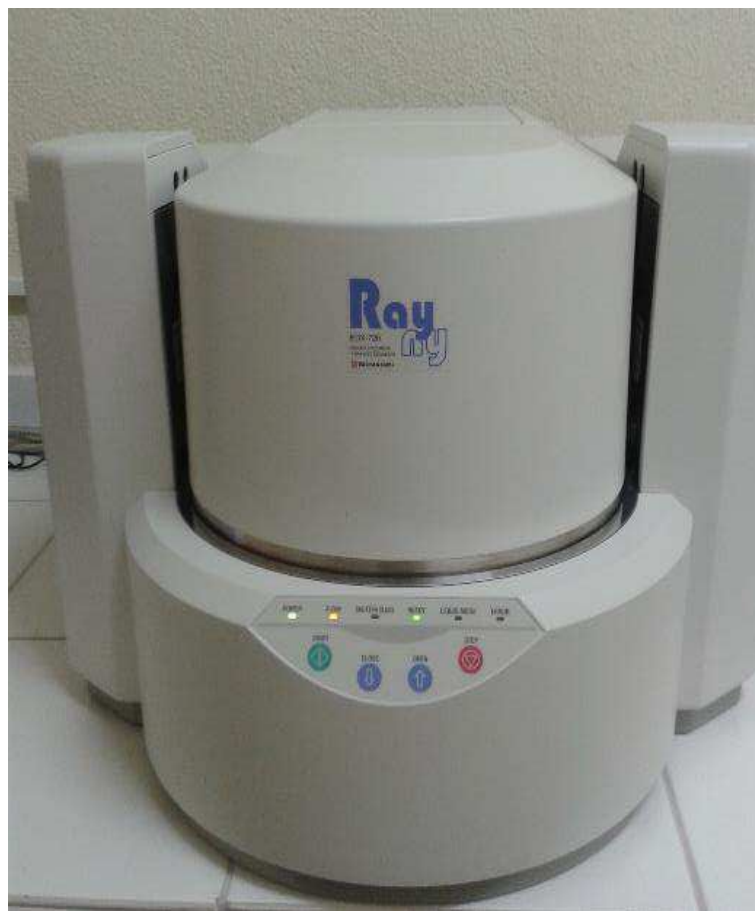
Figura 8 – EDX 720: Equipamento utilizado nas análises de minerais - Laboratório de Eletroquímica e Corrosão (CES/UFCG).
