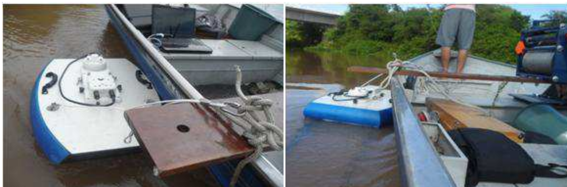
Figura 8: Medição de descarga líquida com o uso do ADCP do Rio Piranhas.
