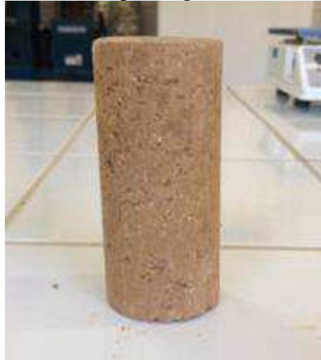
Figura 10: Corpo de prova desmoldado
