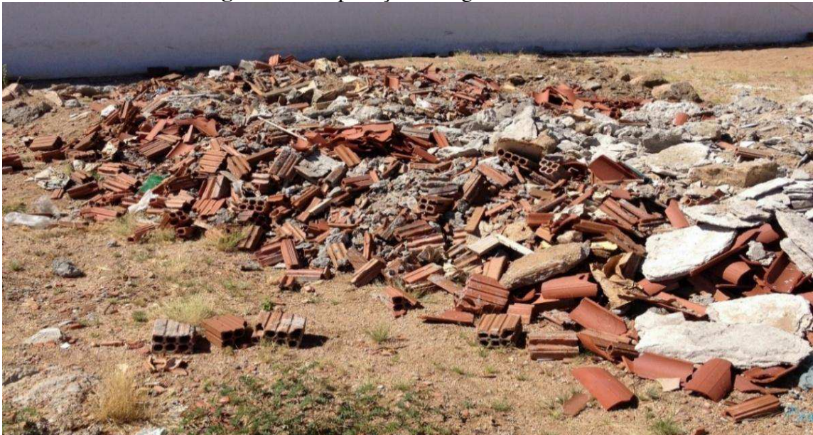
Figura 4: Deposição irregular dos RCD
