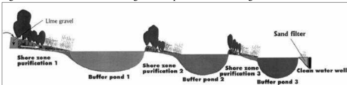
Figura 2 - Sistema de Reuso de Água cinza por Processo Biológico
