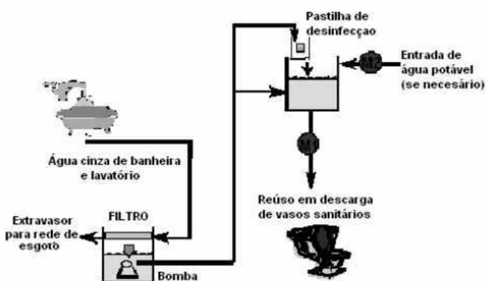
Figura 1 - Sistema de reuso de águas cinza em processo de dois-estágios
