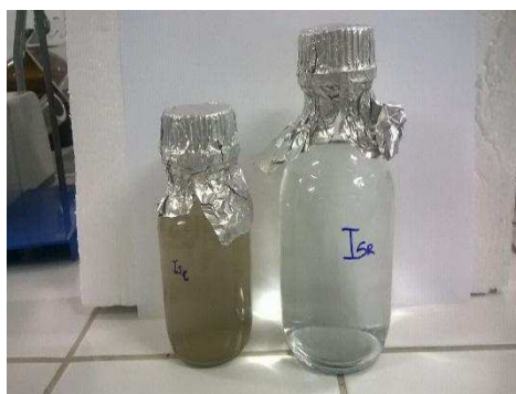
Figura 08 - Água antes e depois da caixa filtrante.
