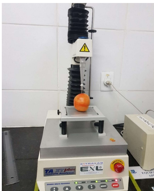
Figura 3.8 - Texturômetro modelo TA-XT plus utilizado para determinação da firmeza
