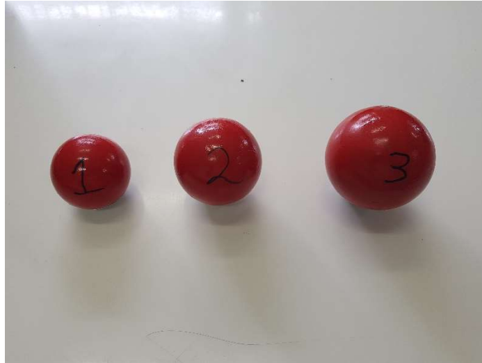
Figura 3.11 – Modelos esféricos com diâmetros diferentes (A, B e C) e mesma massa específica média dos tomates.
