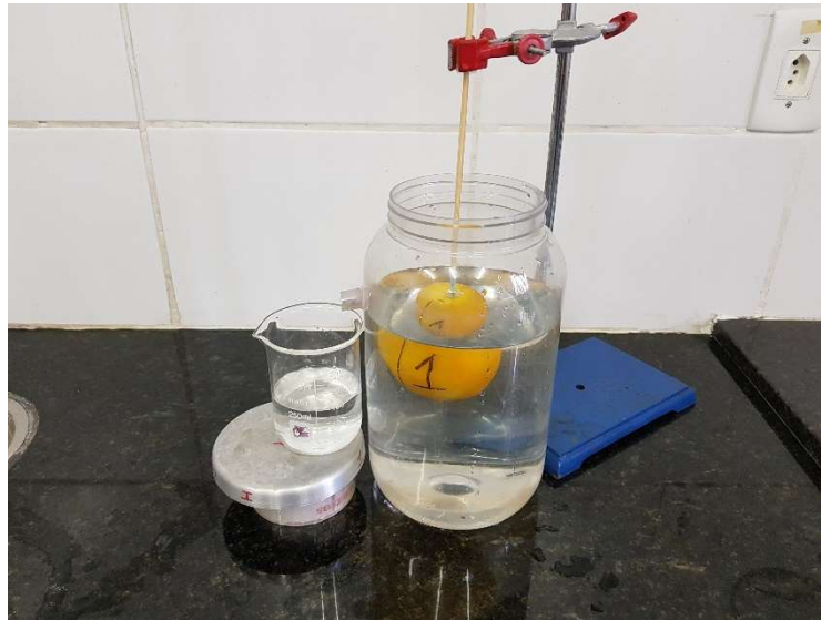
Figura 3.4 - Determinação do volume do fruto
