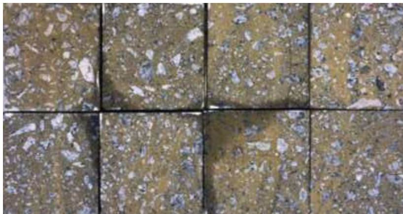
Figura 51 - Placa para medir a refletância e temperatura superficial (cor vermelha)
