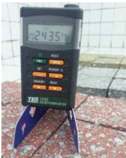
Figura 53 - Medidor de Radiação de Energia Solar
