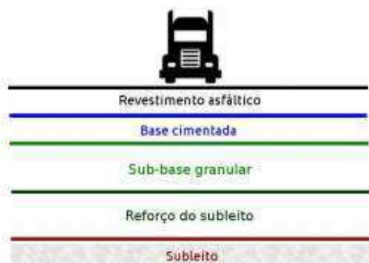
Figura 3 - Estrutura de pavimento semirrígido
