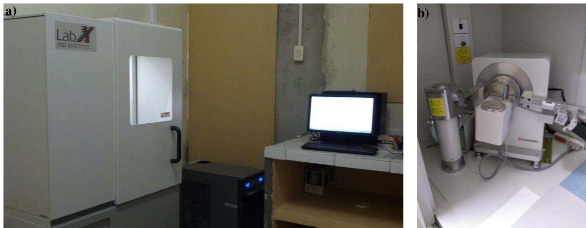
Figura 38 - Difratômetro de raios X modelo XDR-6100 da Shimadzu. a) Equipamento completo e b) Câmara de incidência dos raios x.
