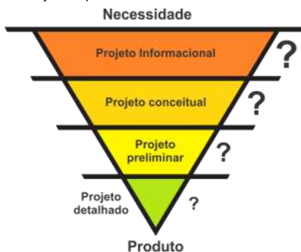
Figura 06 – Representação do processo de desenvolvimento de um produto industrial
