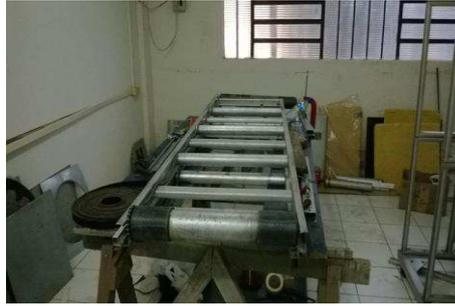
Figura 3.23 - Rolos trator a) e rolo de apoio secundário b) com cubos de bicicleta, Fonte: Holanda (2007).
