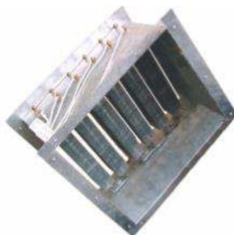
Para o sistema de aquecimento usado para cada módulo, foram feitos com base nos testes realizados por Holanda (2007), dois grupos de resistências foram selecionados e testados. A Figura 3.38 mostra o mesmo grupo de resistências usado para estufa em teste de aquecimento para averiguação de temperatura. As Figuras 3.39 e 3.40 ilustram uma resistência em fase de testes enquanto que a Figura 3.41 já mostra o jogo de resistências após fase de teste sendo instalada no modulo C.
