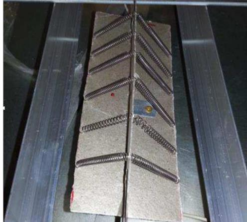
Figura 4.49 - Grupo de resistências montadas numa configuração tipo colmeia. Fonte: Autor (2017).
