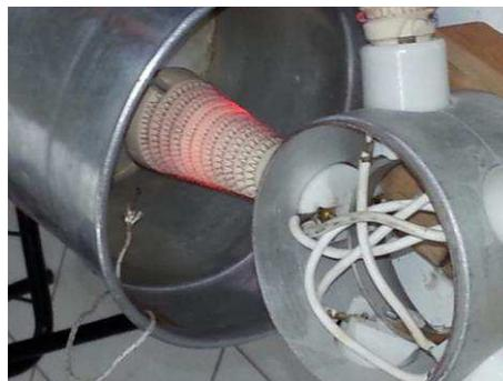
Figura 3.40 - Resistência em fase de teste. Fonte: Autor (2017).
