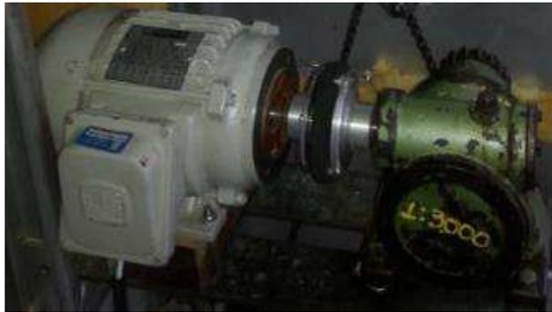
Figura 3.33 – Redutor de velocidade 1/3000. Fonte: Autor (2017).
