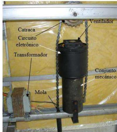
O novo sistema de acionamento do secador de fluxos cruzados consiste de:
