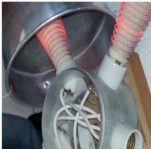
Somente um ponto de incandescência foi observado no interior do cone, porém facilmente corrigível com a mudança no sentido da resistência. Nesse último arranjo, tudo funcionou muito bem, devido a maior abrangência do fluxo de ar (Figura 4.50) sobre o conjunto de resistências.
