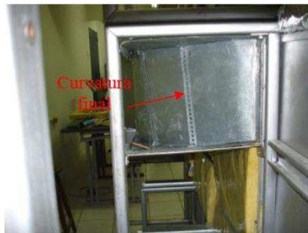
A Figura 3.50 reporta bem essa inclinação lateral, sendo visto através da parte externa do duto, onde força o ar a entrar para a primeira entrada, e o excedente prossegue com maior pressão e velocidade. Assim o ar entra na câmara em condições semelhantes nas duas entradas.
