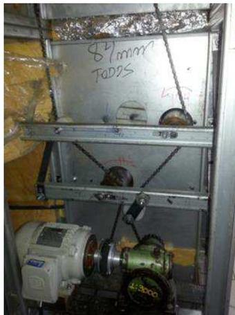
Figura 3.35 - Sistemas de transmissão (coroa e corrente de moto) que interliga todos os rolos trator. Fonte: Autor (2017).
