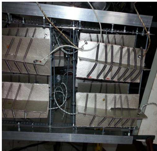
Figura 4.50 – Ventilador soprando o ar sobre o grupo de resistências, no módulo A. Fonte: Autor (2017).
