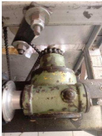
O redutor de velocidade exposto na Figura 3.33 é um equipamento mecânico que tem como função principal a redução da rotação de um acionador “motor”, tem como componentes básicos um conjunto de engrenagens, eixos e rolamentos que tem como
