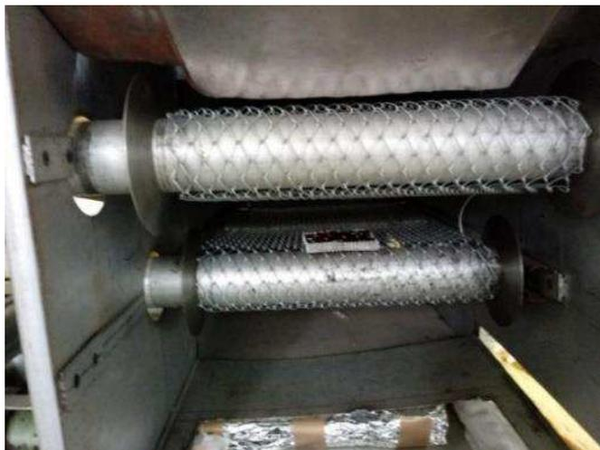
O secador de fluxos cruzado contém três câmaras de secagem. Cada câmara contém duas esteiras que se deslocam em sentidos contrários. Assim, devido a configuração do secador de fluxos cruzados, a secagem foi realizada de duas formas: a primeira, com a esteira estática, e a segunda, com a esteira em movimento. Com a esteira estática, o procedimento experimental foi semelhante (intervalo de tempo) ao experimentado para a secagem em estufa.
