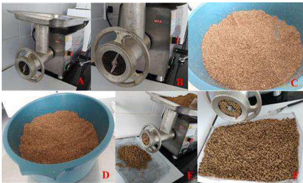
Figura 4.4. Moedor adaptado (A), detalhe da adaptação para a peletização (B), farinhas dos resíduos para a mistura (C), mistura umedecida (D), peletização da ração (E), ração peletizada (F).
