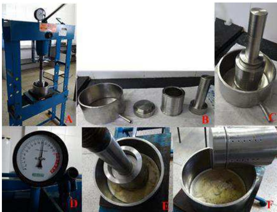
Figura 4.3. Extração do óleo da semente do maracujá. Prensa (A); acessórios (B); Acessórios montados (C); Manômetro (D); acessórios prensando a massa de sementes (E); coletor com o óleo extraído (F).
