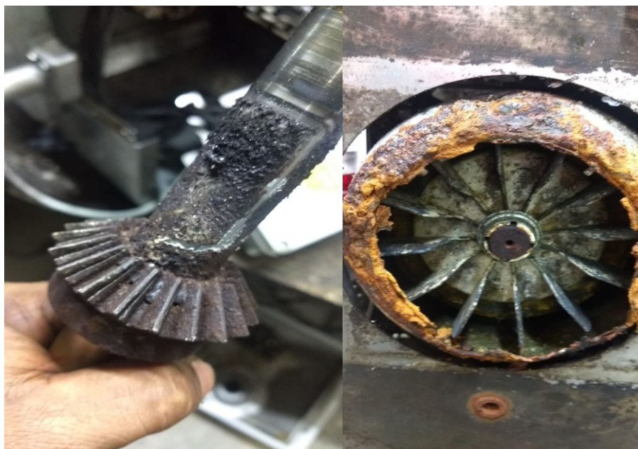
Figura 7 - Interior da máquina modeladora de hambúrguer, estado atual encontrado durante inspeção.
