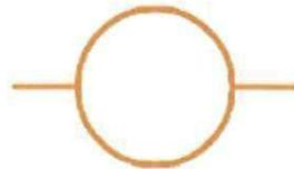
Figura 2.5: Representação Gráfica de um Gerador em um circuito
