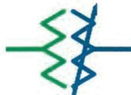
Figura 2.6: Representação Gráfica de um Transformador em um circuito
