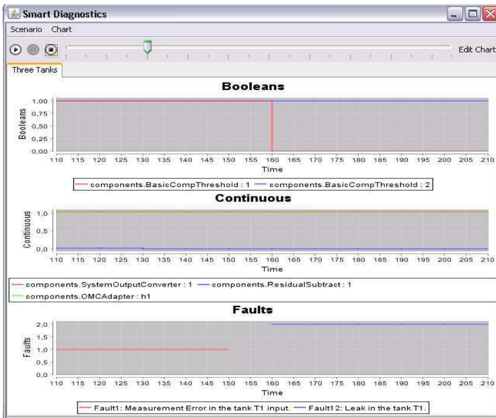
Figura 22: Vazamento no tanque T1.
