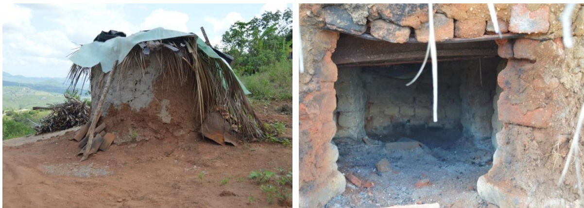
Figura 40 – Forno artesanal para queima das louças de barro
