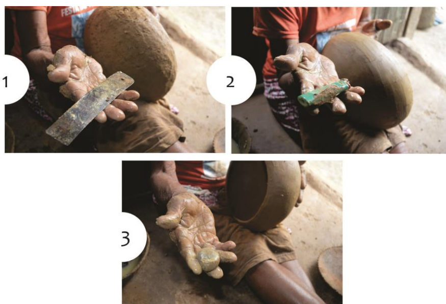
Figura 39 – Instrumentos para acabamento: (1) faquinha; (2) isqueiro; e (3) seixo.
