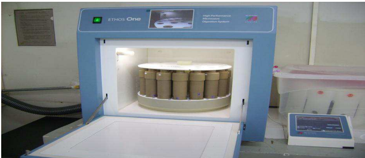
Figura 13 – Forno de digestão em micro-ondas de alta performance para digestão das polpas.
