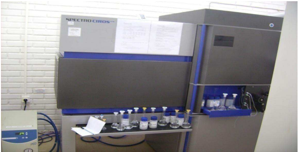
Figura 16 – Aparelho de Espectrometria de Emissão óptica onde foram realizadas as análises das amostras as polpas das Spondias .
