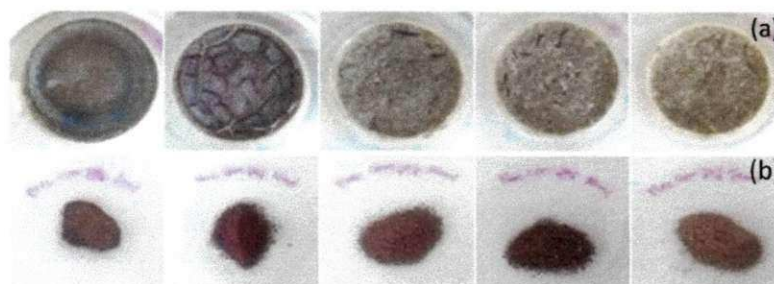
Figura 7: Amostras dos precipitados com \text{Na}_2\text{HPO}_4 secos(a). Amostras dos ensaios secos e macerados (b).
