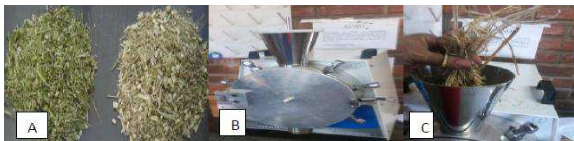
Figura 3.2 – Etapas da preparação: A) Bagaço; B) Moinho de faca; C) Moagem do bagaço.
