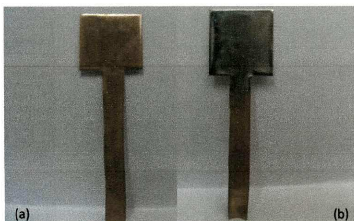
Figura 9 – Imagens superficiais do substrato (a) antes do depósito (b) depois do depósito.
