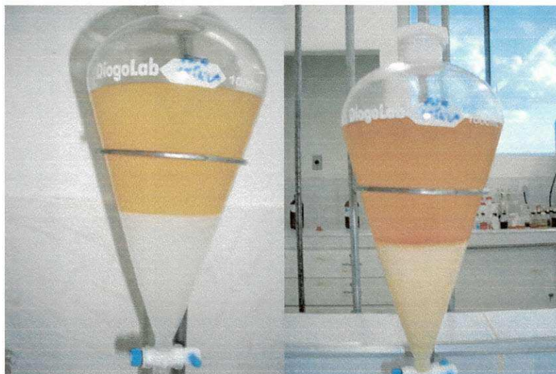
Figura 13 – Processo de lavagem do biodiesel etílico.
