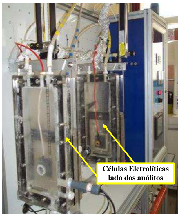
Figura 25 - Detalhe lateral do sistema eletrolítico evidenciando os compartimentos anódicos das duas células.
