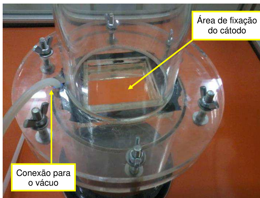
Figura 8 - Detalhe central do sistema para deposição dos diafragmas.
