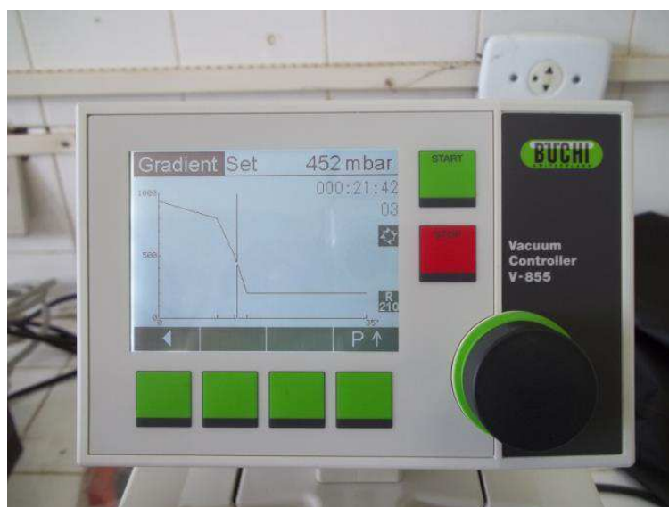
Figura 10 - Controlador V-855 com detalhe do programa em andamento
