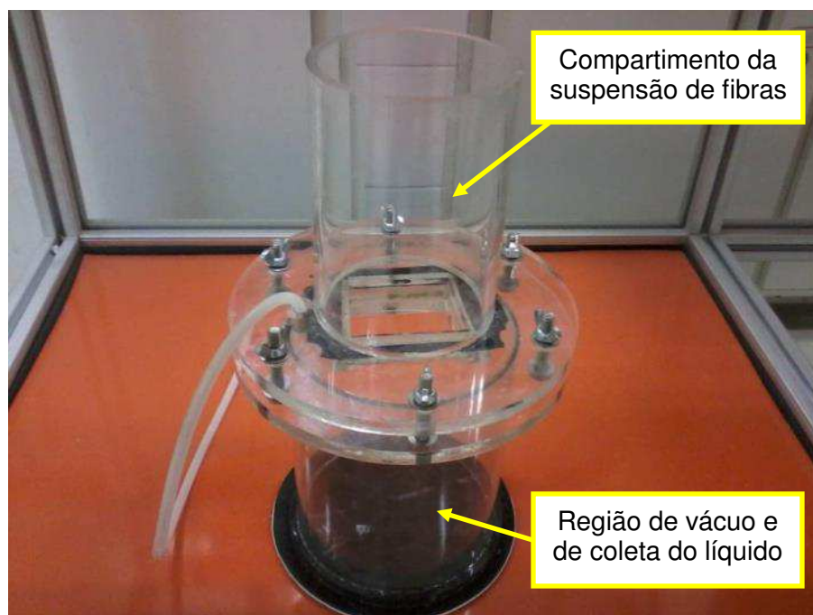
Figura 7 - Novo sistema desenvolvido para deposição dos diafragmas.
