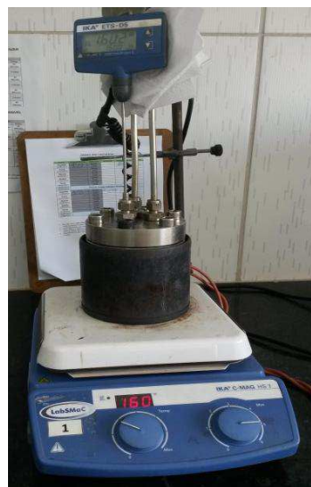
Figura 16 – Reator de inox utilizado para as reações de transesterificação e interesterificação em biodiesel.
