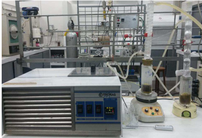
Figura 17 – Reatores de vidro equipado com banho termostatzado e refluxo, utilizado para as reações de esterificação do ácido oleico.
