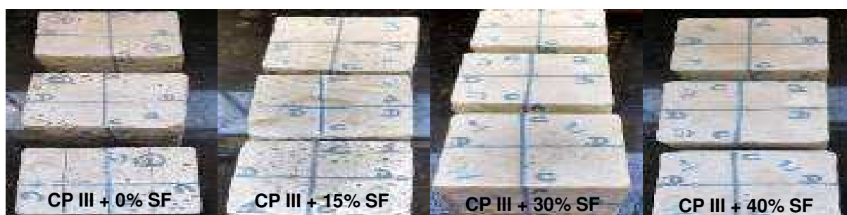
Figura 28 - Corpos de prova das composições de cimento CP III submetidos ao sulfato de sódio.
