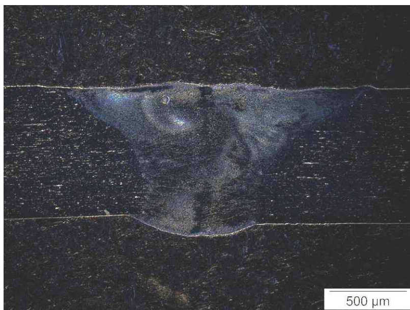
Figura 35. Micrografia ótica da junta atuadora de Ni-Ti soldada na condição de 8ms/65%.
