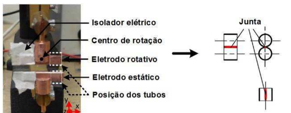
Figura 15. Esquema de montagem dos tubos de Ni-Ti com parede fina para a soldagem por resistência (adaptado de Delobelle et al. , 2013).
