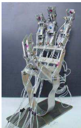
Figura 7. Protótipo de mão robótica desenvolvida com atuadores de LMF (Farias et al. , 2009).
