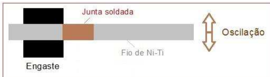
Figura 25. Esquema da montagem dos fios Ni-Ti soldados para ensaio de DMA em modo de flexão com engaste simples.
