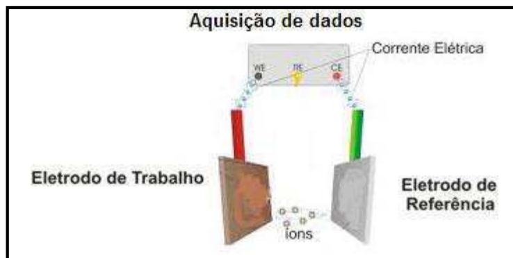
Figura 6: Representação esquemática de uma célula eletroquímica
