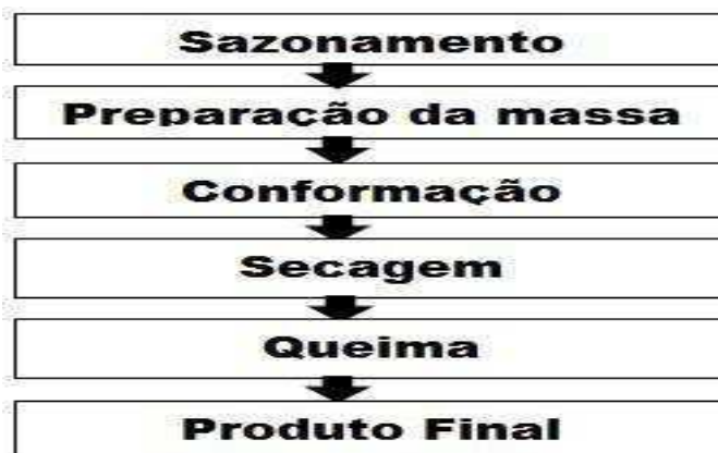
Figura 1 - Fluxograma simplificado do processo de fabricação da cerâmica vermelha.
