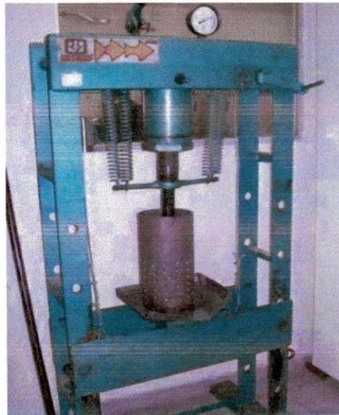
Figura 4. 3 Prensa hidráulica utilizada para extração mecânica. (Fonte do trabalho)
