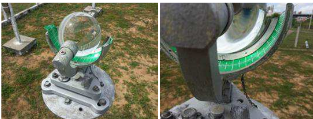
Figura 3.2: Heliógrafo Campbell-Stokes da estação climatológica do INMET em Natal.
