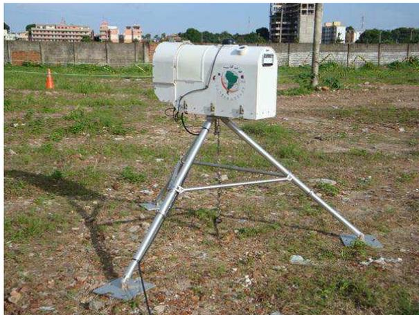
**Figura 6.3** – Radiômetro (*Microwave Profiling Radiometer* - MP3000) instalado do sítio experimental da Defesa Civil, em Fortaleza-CE.
