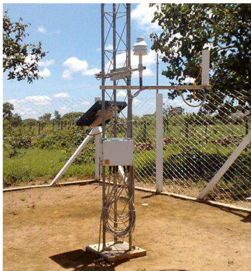
**Figura 3.1** – Exemplo de uma PCD meteorológica.
