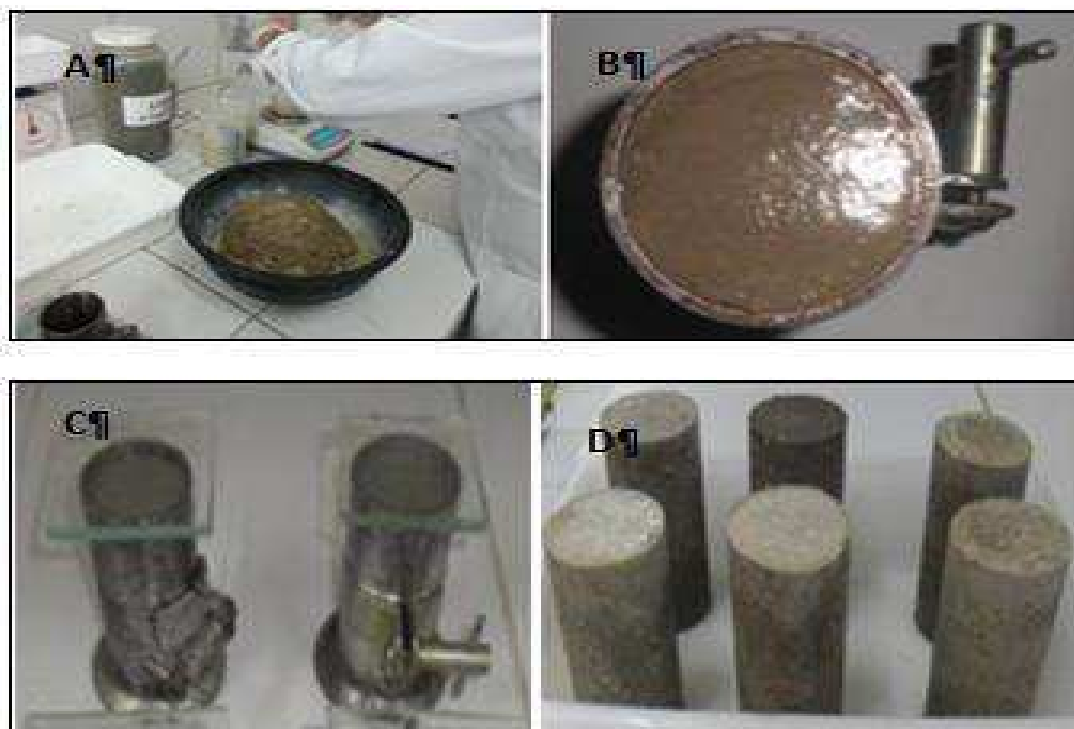
Figura 7. Etapas da preparação dos corpos de prova das matrizes cimentíceas.
