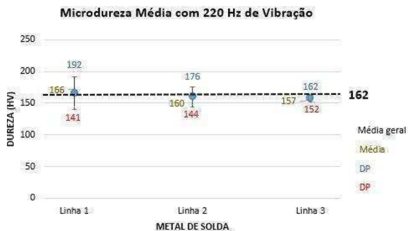
Figura 58 – Perfil de microdureza média para a C8
