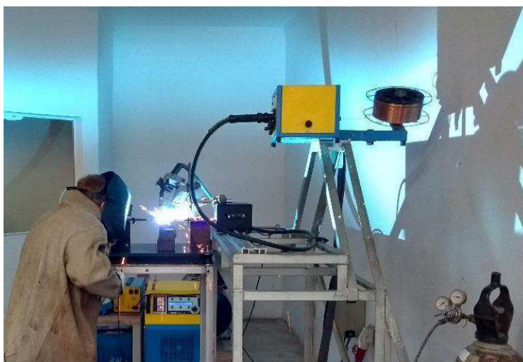
Figura 22 – Soldagem das chapas pelo processo GMAW
