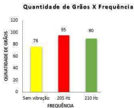
Figura 48 – Quantidade de grãos versus frequência de vibração
