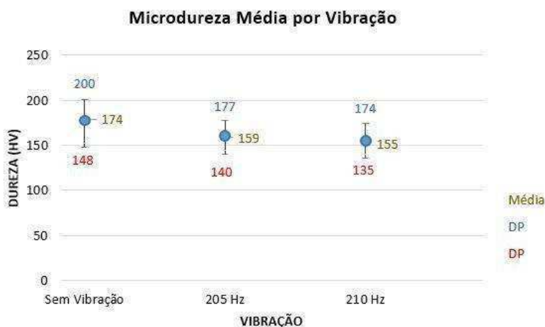
Figura 53 – Perfil de microdureza média para cada condição de soldagem SMAW
