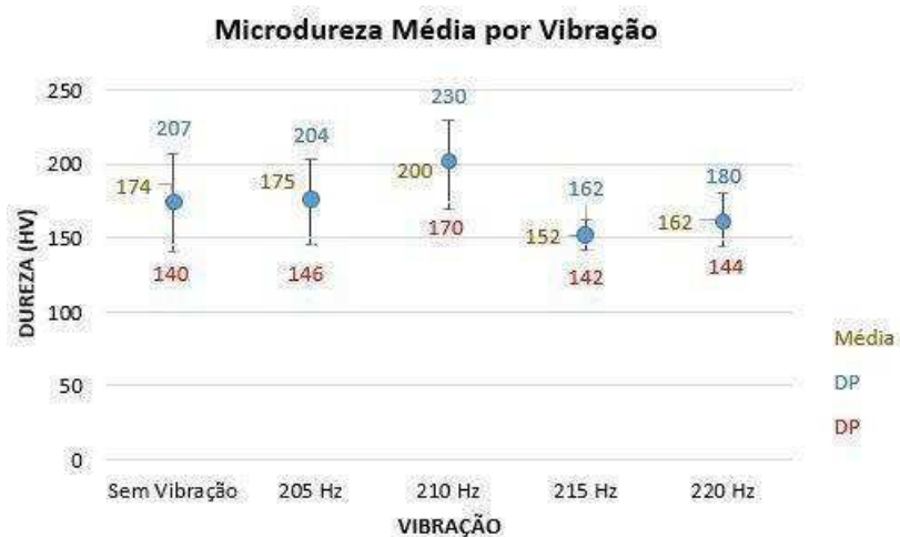
Figura 59 – Perfil de microdureza média para cada condição de soldagem GMAW
