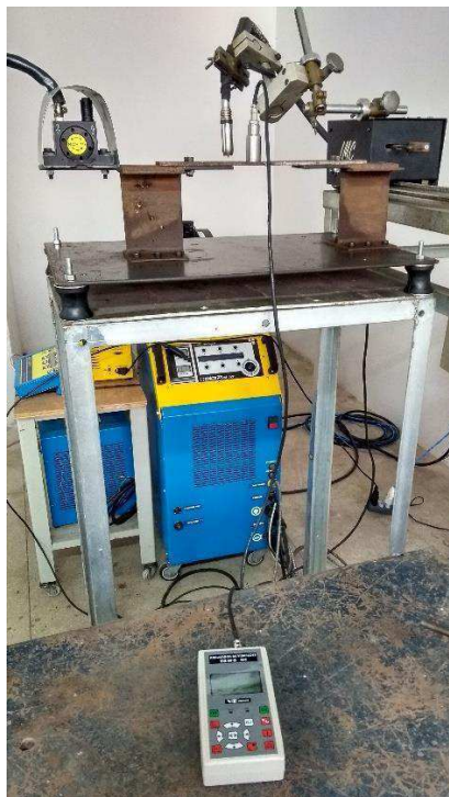
Figura 30 – Bancada e instrumentação de coleta dos espectros de frequência na junta, com aparelho analisador de campo (Vibtron)
