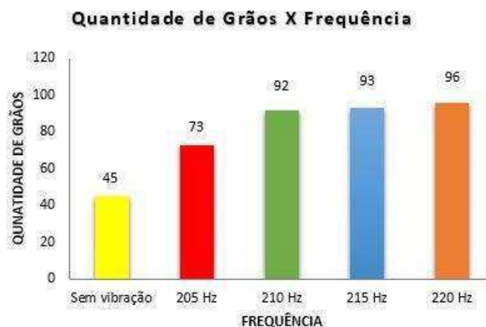
Figura 49 – Quantidade de grãos versus condição de soldagem
