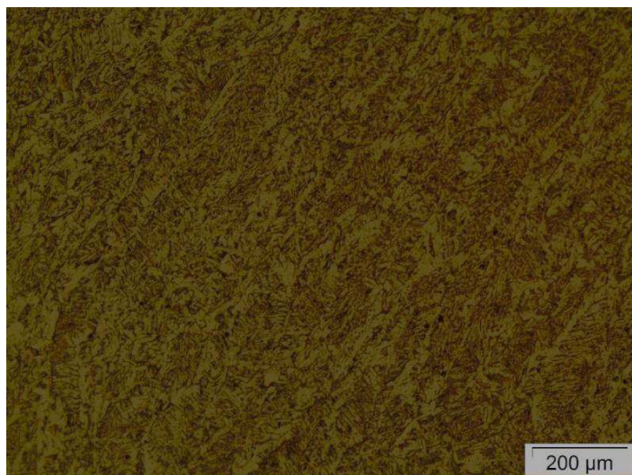
Figura 41 – Microestrutura da amostra com 205 Hz (C2): Aumento 100X com nital 2%
