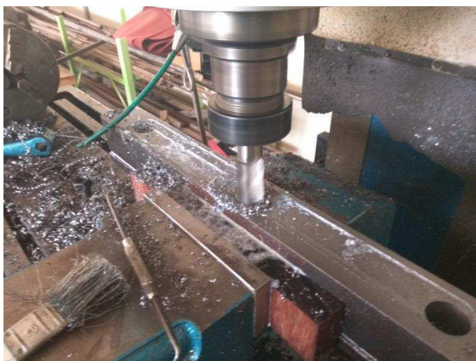
Figura 101 Fresagem da Base inferior do dispositivo.
