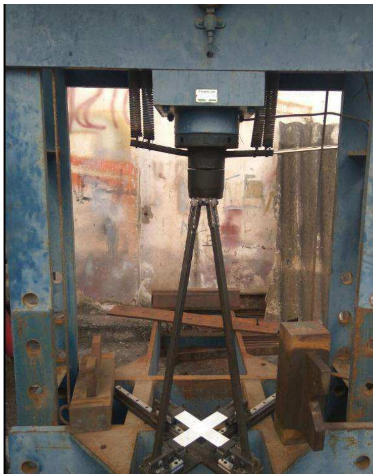
Figura 133 Terceiro teste usando a prensa de 150 t.
