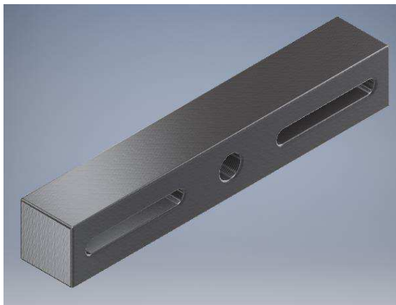
Figura 89 Base superior para acoplamento no ponto de aplicação de carga.
