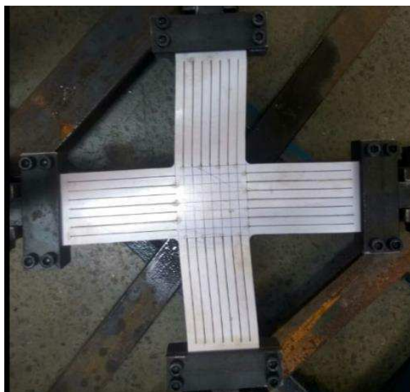
Figura 131 Desalinhamento do corpo de prova durante teste.
