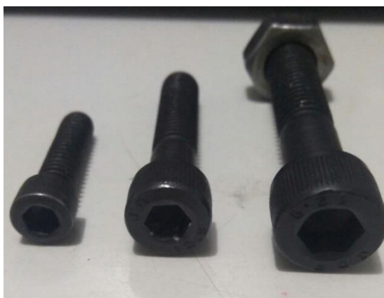
Figura 118 Parafusos selecionados 1/4" BSW, M8 e M10
