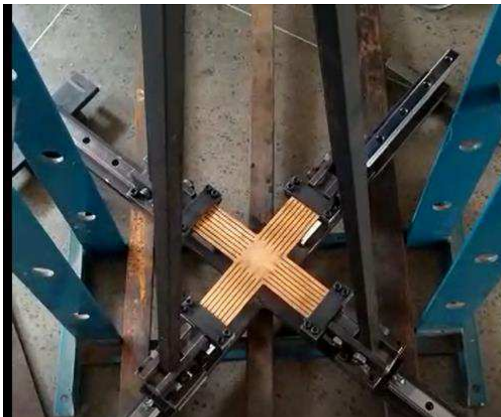
Figura 126 Realização do teste de rigidez.
