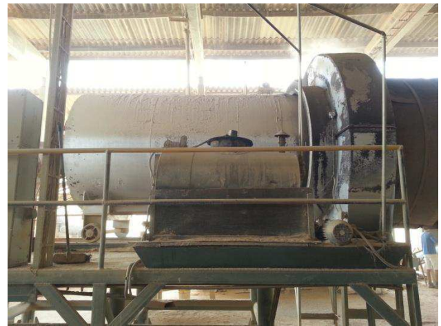
Figura 3.2: Câmara de queima do combustível. Fonte: Empresa Bentonit União Nordeste
