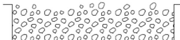
Figura 2.9 – Condição estática dos sólidos (secador de bandeja). Fonte: PERRY e GREEN (2008)
