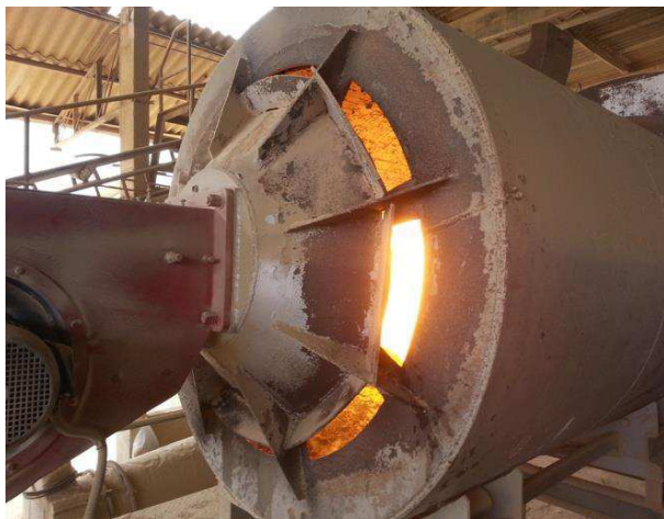
Figura 3.2: Câmara de queima do combustível. Fonte: Empresa Bentonit União Nordeste
