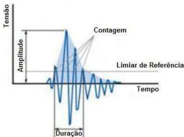
Figura 8 – Parâmetros característicos de um sinal transiente de EA (Tiboni, 2011).
