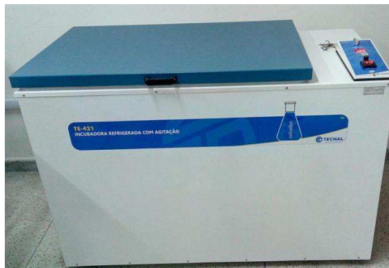
Figura 3.14: Incubadora refrigerada com agitação utilizada para a desidratação osmótica.
