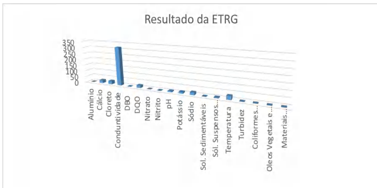
Figura 14 - Dados Médios dos Parâmetros Alumínio, Cálcio, Cloreto, Condutividade, DQO, Nitrato, Nitrito, Potássio, sódio, Sólidos Sedimentáveis, Sólidos Suspensos Totais, pH, Temperatura e materiais Flutuantes e Coliformes Totais do efluente na saída da ETRG em Várzea Alegre – CE.
