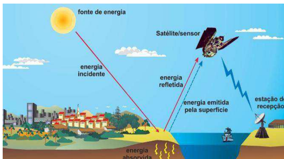
Figura 2-- Obtenção de imagens satelitais da superfície terrestre
