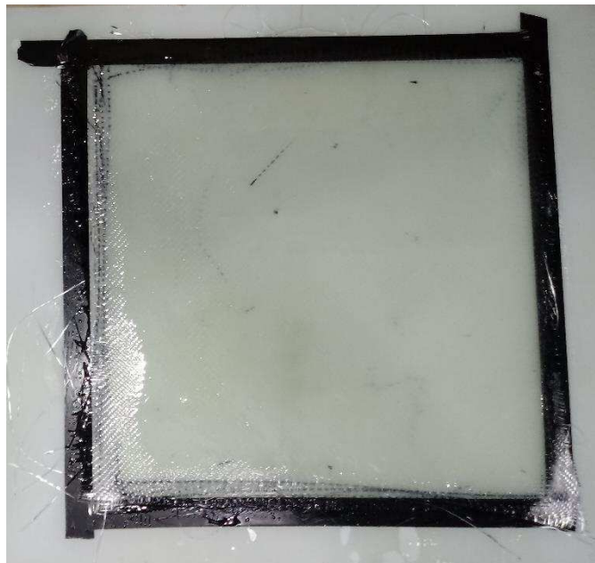
Figura 48 - Placa de material compósito convencional após cura total de 7 dias.
