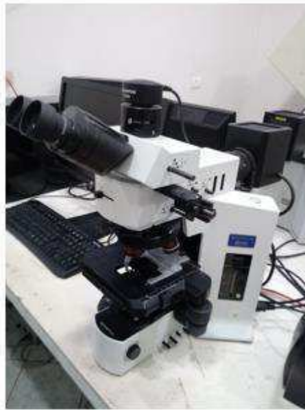
Figura 52 - Equipamento utilizado para análise geométrica e dimensional, microscópio ótico BX-51.
