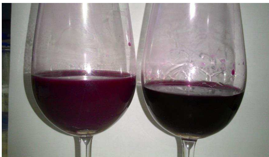
Figura 20 – Amostra 4 antes e o depois do tratamento com a MC na pressão de 1bar. Na esquerda o vinho antes do tratamento e na direita o vinho após microfiltração com membrana cerâmica.
