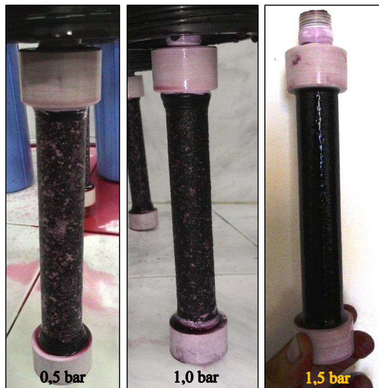
Figura 17 – Visualização da formação de “ fouling ” na membrana após a filtração da amostra 4 com pressões 0,5, 1,0 e 1,5 e 1,5 bar.
