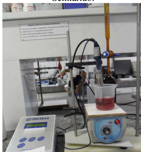
Figura 11: pHmetro (Tecnal, modelo Tec-3MP) do laboratório de Enologia da Embrapa Semiárido.
